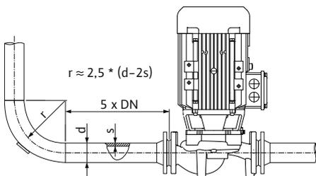
Fig. 16: Odcinek wyrównywania z przodu i z tyłu pompy
