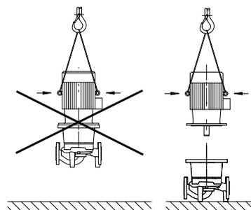
Fig. 7: Транспортировка электродвигателя
