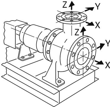
Fig. 11: Допустимые усилия и моменты на фланцах насосов — насос из серого чугуна
