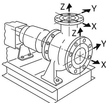
Fig. 11: Tillåtna krafter och moment på pumpflänsarna – gjutjärnpumpar
