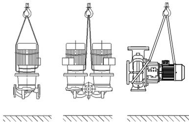
Fig. 6: Транспортировка насоса
