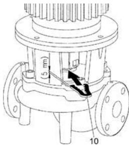
Fig. 18: Монтажная вилка для работ по настройке
