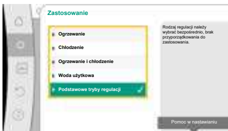
Fig. 44: Wybór zastosowania „podstawowe rodzaje regulacji”
