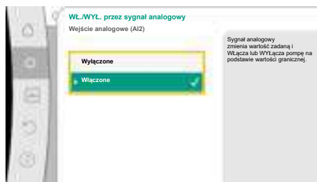
Fig. 79: WŁ./WYŁ. przez sygnał analogowy
