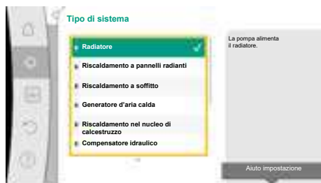
Fig. 41: Esempio tipo di sistema “Radiator”
