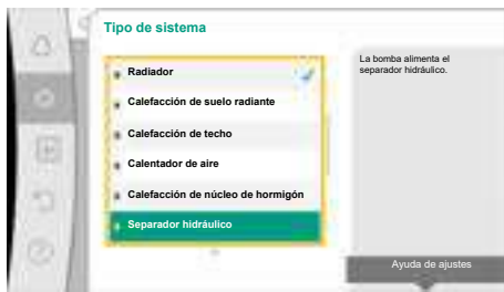
Fig. 54: Tipo de sistema «Separador hidráulico»
