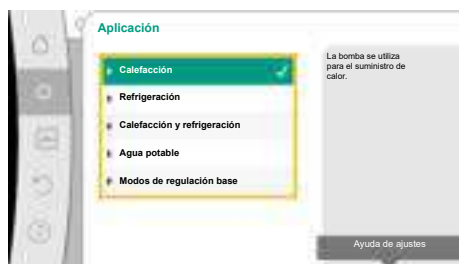
Fig. 40: Ejemplo aplicación «Calefacción»
