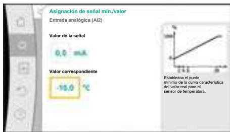
Fig. 86: Asignación de señal mín./valor de sensor de valor real
