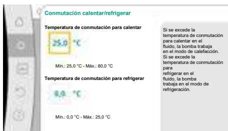
Fig. 51: Conmutación calefacción/refrigeración_Temperaturas de conmutación
