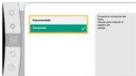
Fig. 96: Corrección de fluido
