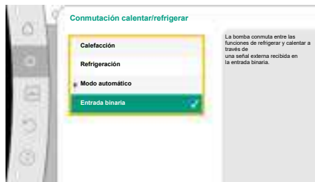
Fig. 52: Conmutación calefacción/refrigeración_Entrada binaria
