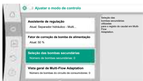
Fig. 57: Assistente de regulação – Seleção das bombas secundárias
