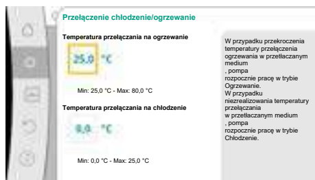
Fig. 51: Przełączenie chłodzenie/ogrzewanie_temperatury przełączenia
