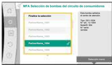
Fig. 58: Selección de las bombas secundarias para Multi-Flow Adaptation
