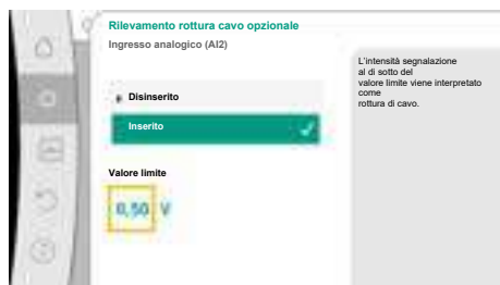
Fig. 78: Valore limite rottura di cavo
