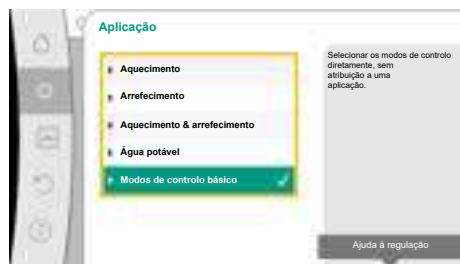
Fig. 44: Seleção da aplicação «Modos de controlo básico»
