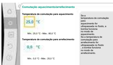
Fig. 51: Comutação aquecimento/arrefecimento_Temperaturas de comutação
