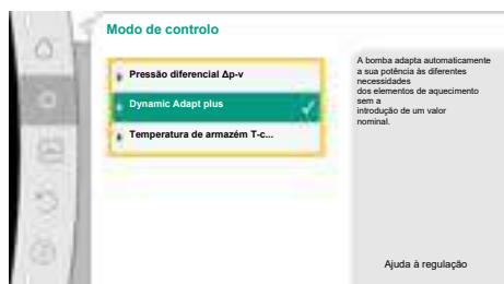
Fig. 42: Exemplo de modo de controlo «Dynamic Adapt plus»
