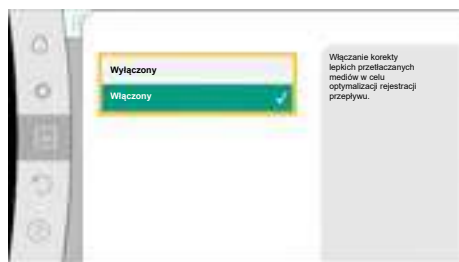
Fig. 96: Korekta przetwarzanych mediów
