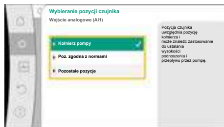
Fig. 69: Wybieranie pozycji czujnika
