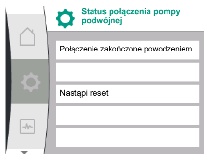
Fig. 51: Połączenie pompy podwójnej zakończone powodzeniem
