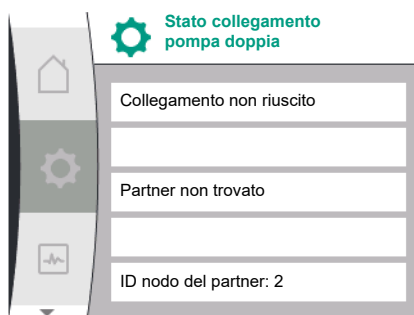
Fig. 52: Collegamento doppio fallito
