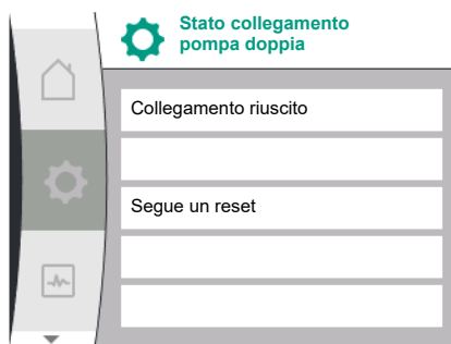
Fig. 51: Collegamento di pompa doppia riuscito
