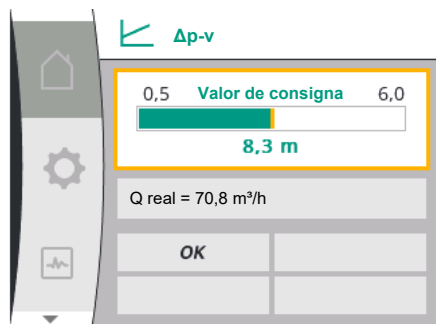
Fig. 32: Ajuste del valor de consigna en la pantalla de inicio \Delta p-v
