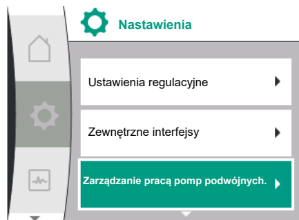
Fig. 48: Menu Zarządzanie pracą pomp podwójnych
