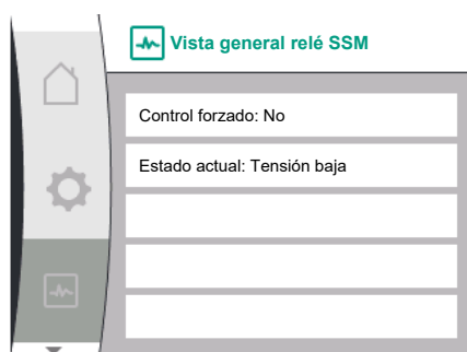
Fig. 93: Vista general de la función del relé SSM
